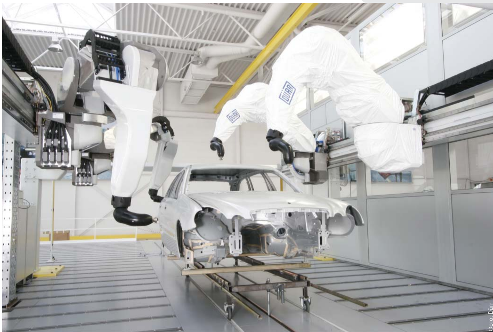
Процесс покраски автомобиля с помощью робототехники
